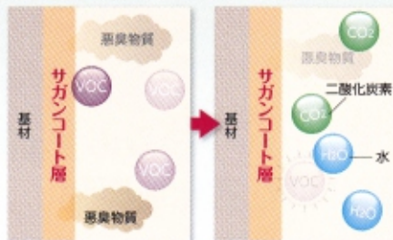
空気中に含まれるVOCや悪臭原因物質を分解します。光触媒によって分解された、VOCや悪臭原因物質は水と二酸化炭素に酸化されます。
